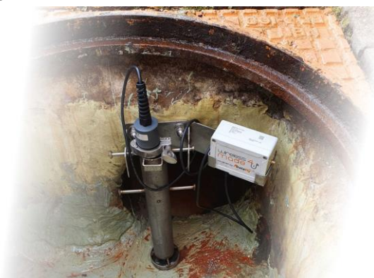
Měření pH odpadních vod v kanalizaci v Belgii
